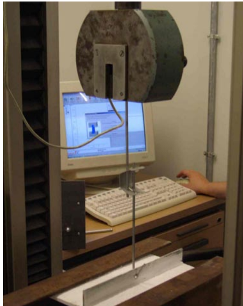
T-Profil, 250 mm, einlaminiered und Doppelfeder mit Öse und Haken, Zugbelastung senkrecht zur Plattenebene,
